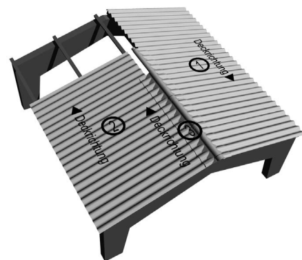
Verlegeschema für Wellfirsthauben WF 2-teilig
